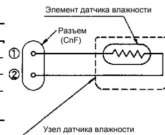
Примечание: не проверяйте датчик влажности на предмет замыкания при помощи тестера, поскольку постоянный ток через датчик может повредить его.
