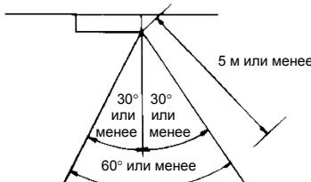
Примечания. (1) При работе пульт ДУ должен быть направлен на приемный элемент на блоке.
