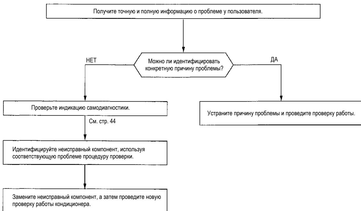
Примечание (1). Даже в случае периодической остановки кондиционера он может быть в норме. Но если одна и та же защитная функция срабатывает постоянно (3 или более раз), это приведет к жалобам со стороны пользователя. Сопоставляйте состояние кондиционера с жалобами клиента.
