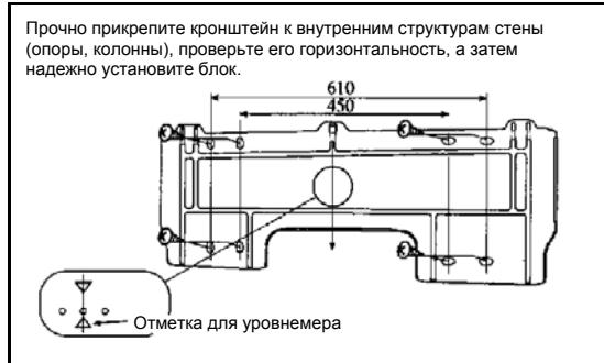
Заверните шурупы (не до конца) и скорректируйте положение кронштейна так, чтобы он был расположен горизонтально.
