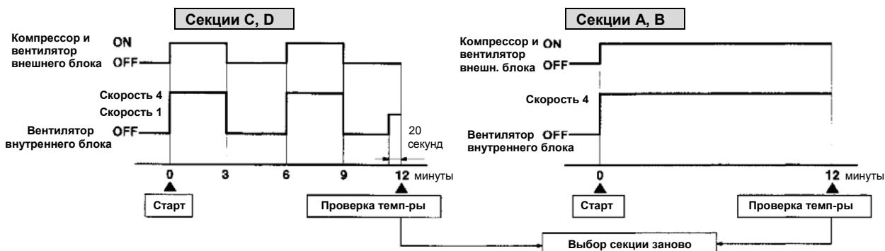
Примечание (1). Термостат работает в секциях А и В. Когда компрессор и вентилятор внутреннего блока останавливаются термостатом в течение 12 минут с момента старта, производится проверка температуры, прежде чем истекут эти 12 минут, во время которой вентилятор работает на скорости 1 в течение 20 секунд, что позволяет принять решение о том, какую секцию использовать далее.
