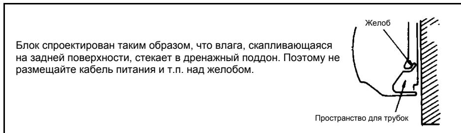
**Установка дренажного трубопровода**
