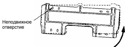
Установите кронштейн в горизонтальное положение, поворачивая его вокруг неподвижного отверстия.
